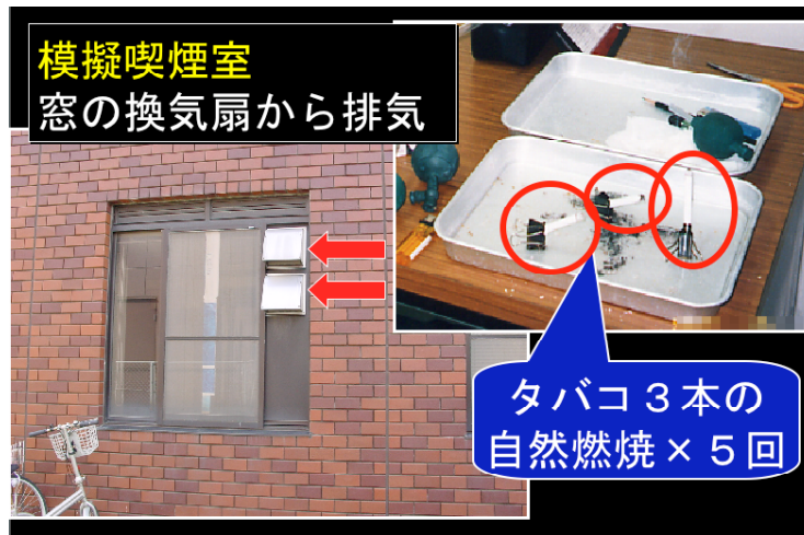
図1. 模擬喫煙室におけるタバコ3本の自然燃焼実験
