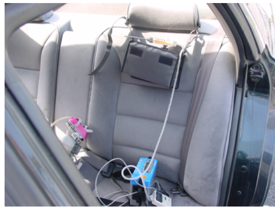
図4. 車内における受動喫煙曝露濃度評価の測定風景 ヘッドレストに粉じん計を設置
