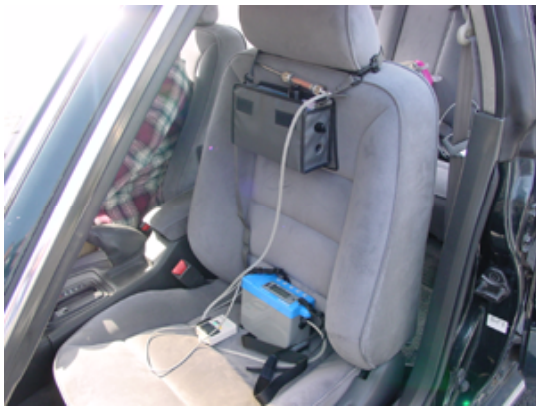
図4. 車内における受動喫煙曝露濃度評価の測定風景 ヘッドレストに粉じん計を設置
