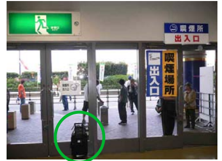
ドアの内側に粉じん計をセット。して逆流の程度を評価。
