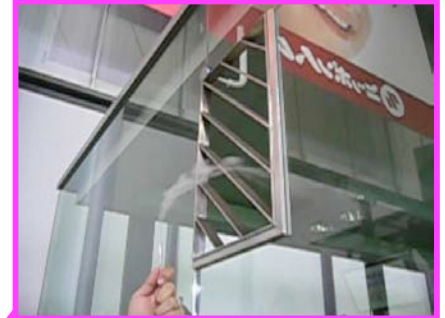
出入口の空気取入口(ガラリ)、 ドアが閉まった状態であれば、 1.0m/sの気流があり煙の漏れはない
